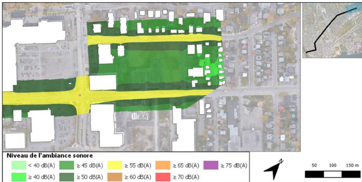
Figure 23 : Cartographie du bruit existant – Secteur du Pôle d’Estimauville, - Niveau de bruit en période nocturne L_n – Hauteur 4m
