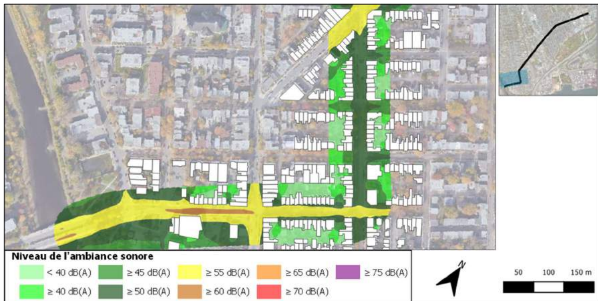
Figure 19 : Cartographie du bruit existant – Secteur de la 4 e Rue et de la 4 e Avenue - Niveau de bruit en période nocturne L_n – Hauteur 4m
